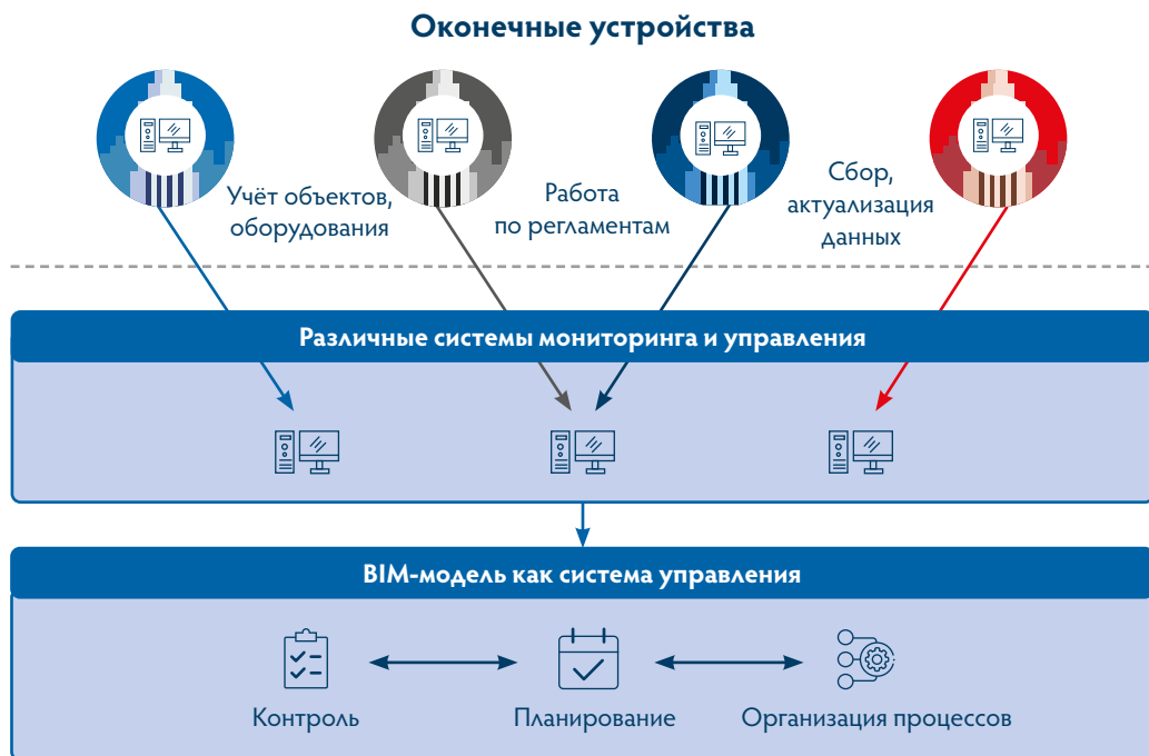
Рис. 5.2. Общая структура решения для управления эксплуатацией объекта на основе технологии информационного моделирования.
