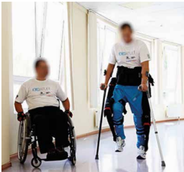
Рис. 8.6. Экзоскелеты ExoAtlet, применяемые в ФГБУ «НМХЦ им. Н. И. Пирогова» Минздрава России для восстановления двигательных навыков пациентов.
